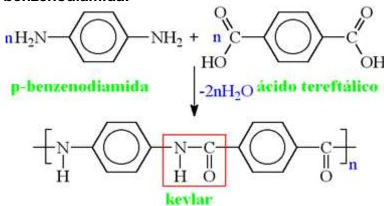
O kevlar é um polímero muito resistente, que é usado em coletes à prova de balas, chassis de carros de corrida, bicicletas e aviões.
